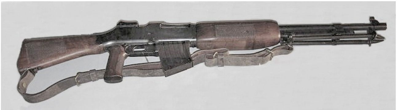
Kulsprutegevär m/21 med infällda benstöd. Gevärets konstruktion medgav ej pipbyten.
